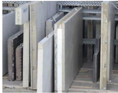
Gambar 4.28 Precast Concrete untuk External Walls
