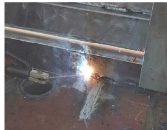
Gambar 7. Pengelasan dengan SMAW pada bimetal
