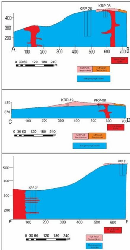
Gambar 6. Penampang litologi bawah permukaan berdasarkan data pemboran
