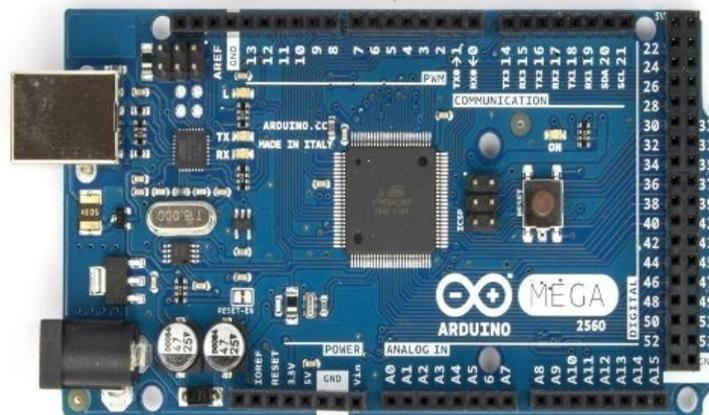
Gambar 2.10 Arduino Mega 2560<sup>[10]</sup>
