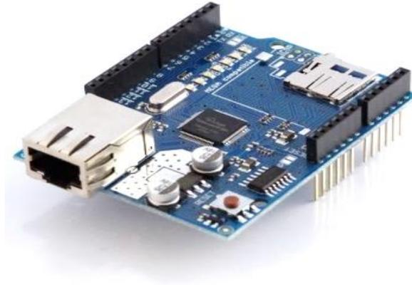
**Gambar 2.13** *Ethernet Shield*<sup>[13]</sup>
