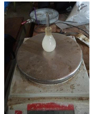
Uji Densitas Untuk Mencari Massa Air
