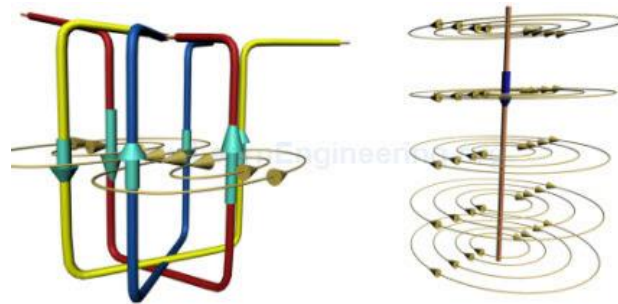
Gambar 2.16. Arus pada Kabel menghasilkan Fluks
