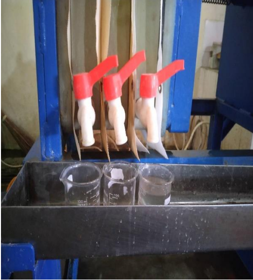
Gambar 8.5 Hasil filtrat yang keluar pada saat pengoperasian alat
