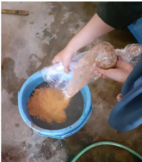
Gambar 8.5. Penambahan Pengkondisi ke Sludge
