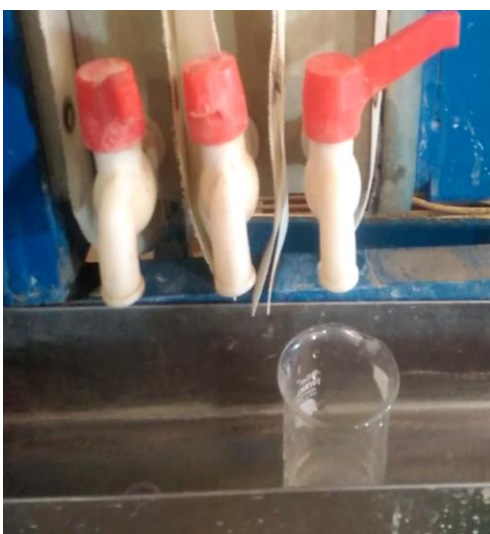
Filtrat hasil proses filtrasi menggunakan plate and frame filter press
