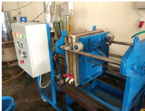
Gambar 2. Proses Filtrasi dengan alat Filter Press Plate and Frame
