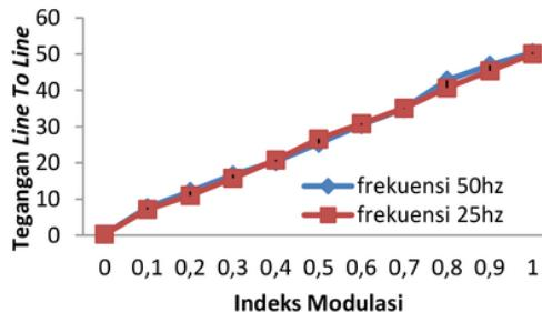
Gambar 18. Grafik  $m_a$  -  $V_{LL}$  kondisi tanpa beban
