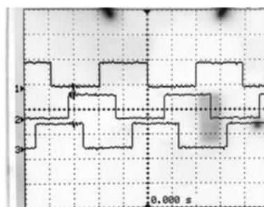
Gambar 13. Beda fase 120° PWM1H, PWM2H dan PWM3H
