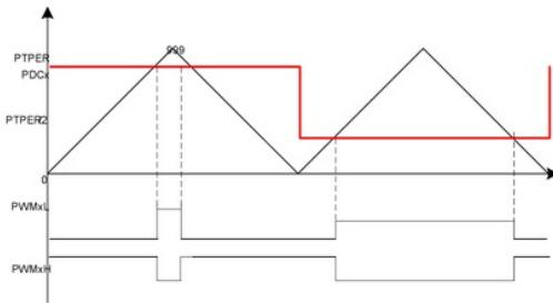
Gambar 10. Komparasi sinyal referensi dengan *carrier*
