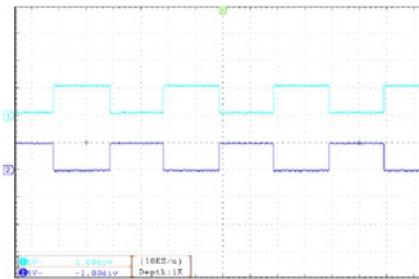
Gambar 11. Output PWM1L dan PWM1H
