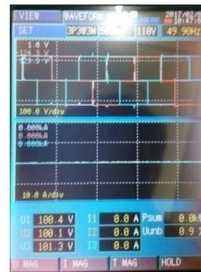
Gambar 16. Output  $V_{LL}$  *Inverter* tiga fase
