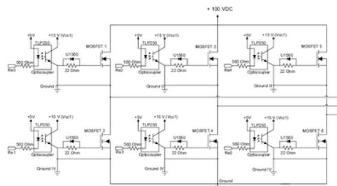
Gambar 3. Rangkaian *Inverter* tiga fase
