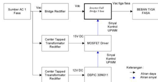
Gambar 1. Blok Diagram Alat
