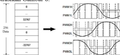
Gambar 8. Sinyal sinusoidal tiga fase dengan look-up table
