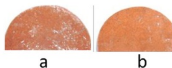
Gambar 3 Foto hasil genteng glasir .(a) pembakaran tunggal dan (b) pembakaran ganda
