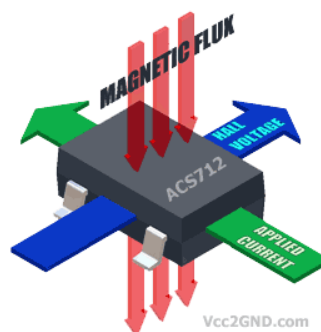
Gambar 2.16. Efek Hall Sensor Arus
