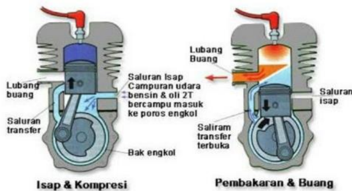
Gambar 2.2 Proses kerja motor bensin 2 langkah 2
