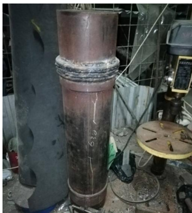
Gambar 3.15. Poros penggerak vertikal (Sumber: Dokumentasi Pribadi)
