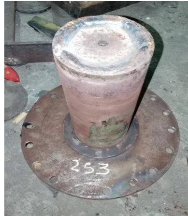
Gambar 3.11. Bushing (Sumber: Dokumentasi Pribadi)
