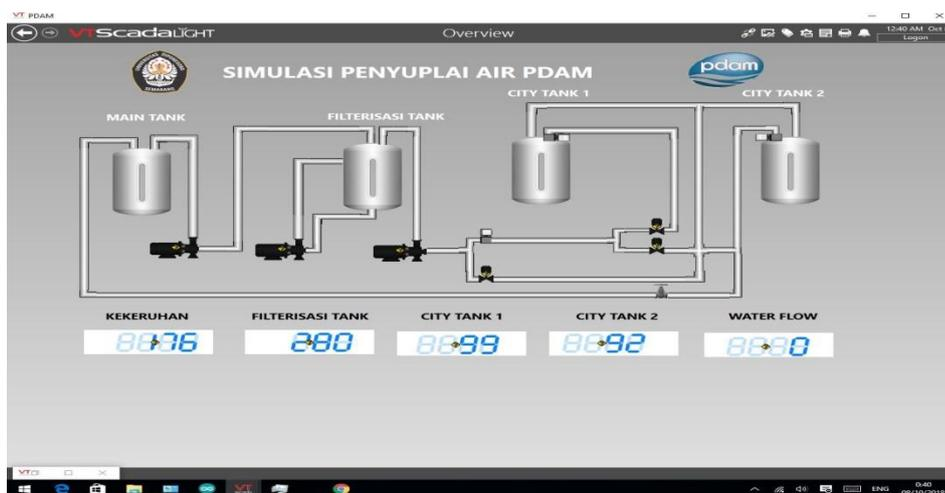
Gambar 5.4 Monitoring Simulasi Sensor Kekeruhan Ketika Air Jernih
