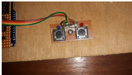
Gambar 4.8 Rangkaian push button yang telah dirangkai
