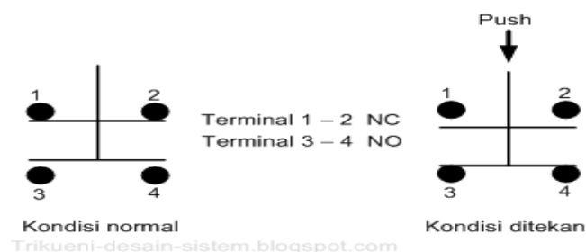
Gambar 2.22 Prinsip Kerja Push Button
