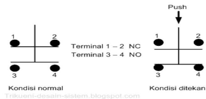
Gambar 2.4 Prinsip Kerja Push Button
