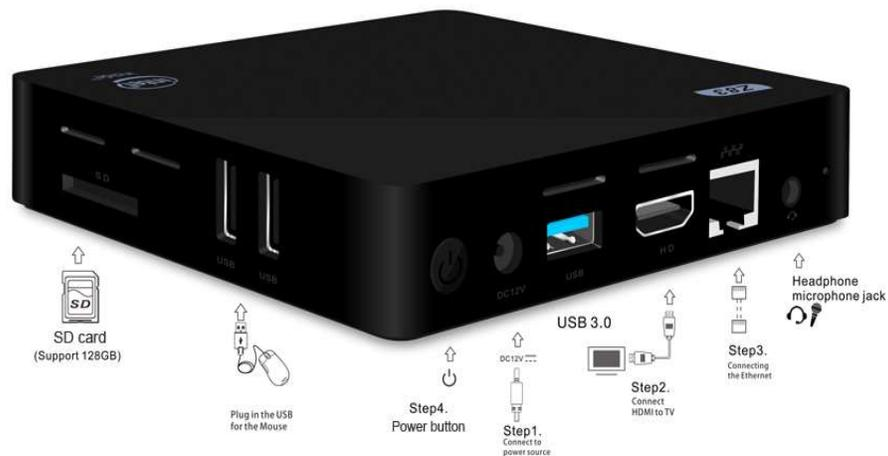
**Gambar 2.36** Bentuk fisik *mini PC*.<sup>[19]</sup>
