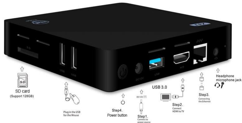
**Gambar 2.28** Bentuk fisik *mini PC*
