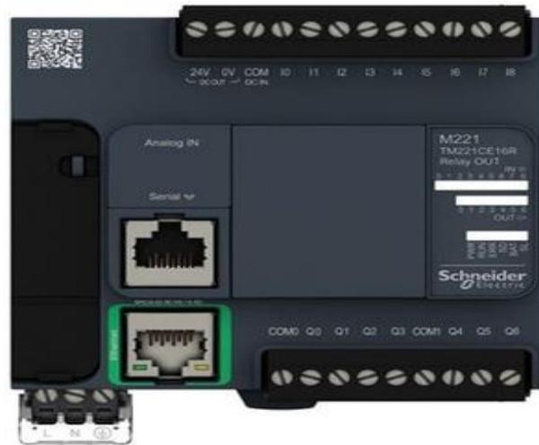
**Gambar 2-9** Bentuk fisik PLC modicon TM221CE16R
