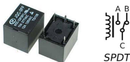
Gambar 2.11 Bentuk dan Simbol Relay [10]
