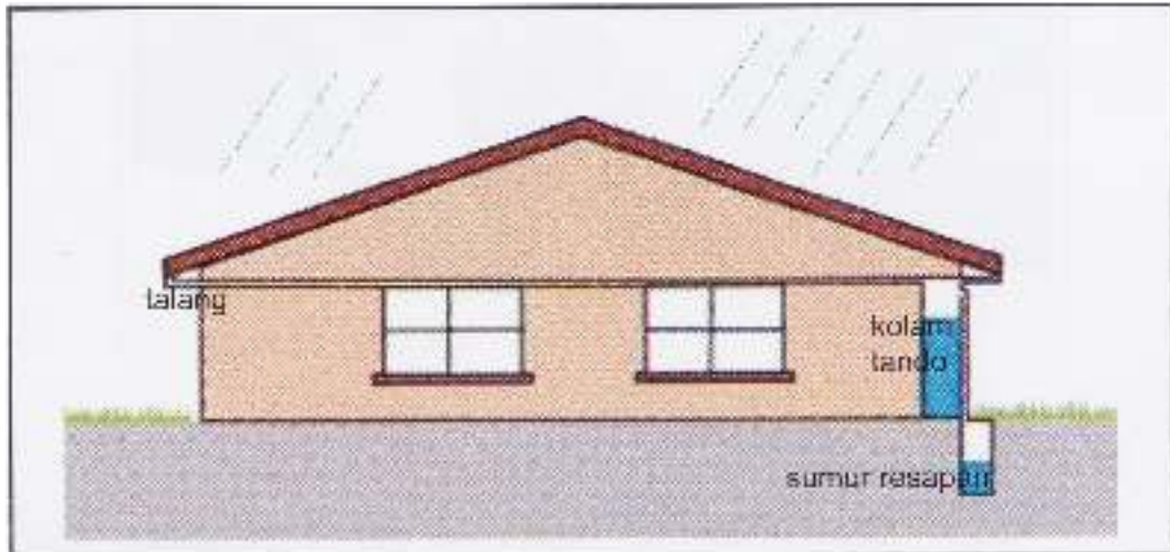
Gambar 2.3. Sketsa Kolam Pengumpul Air Hujan Vertikal (Sumber : Maryono, 2006)
