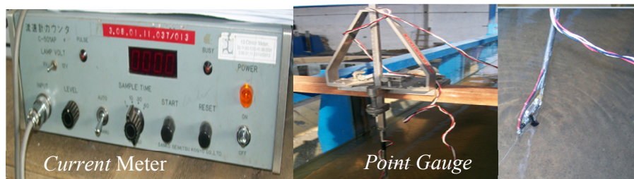
Gambar 3-7. Alat Pengukuran Kecepatan Aliran ( Current Meter )
