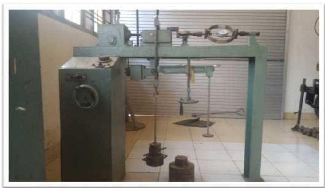
Gambar 3-6. Alat Uji Geser Langsung
