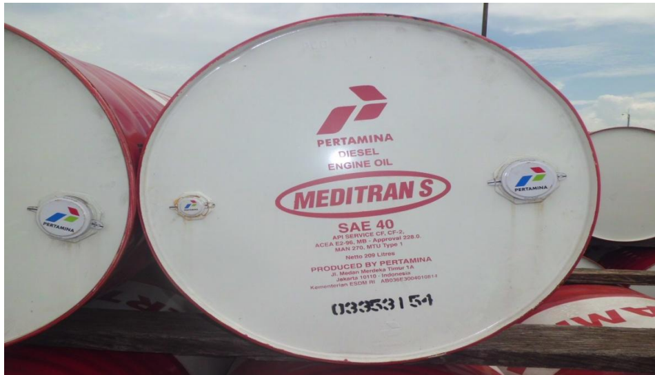
Gambar 3.4 Posisi yang benar saat menimbun Drum (jam 3-9)
