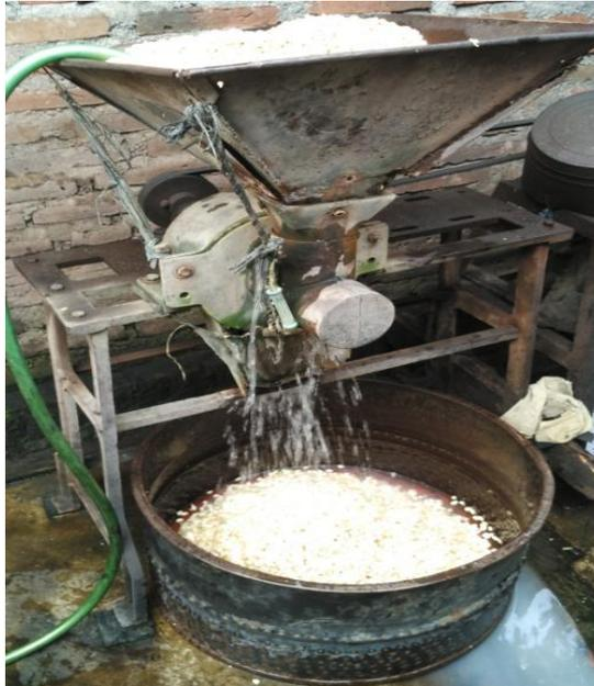
Gambar 6. Proses Penggilingan Kedelai
