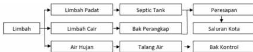
Gambar 5.2. Skema Jaringan Drainase dan Air Kotor
