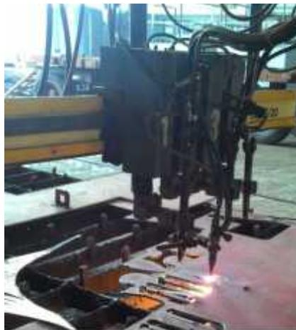
Gambar 2.9 Mesin CNC
