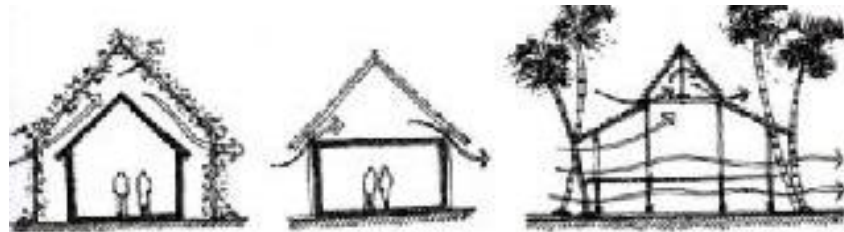
Gambar 2.4 Berbagai Jenis Ventilasi (ki-ka) ventilasi melalui atap dan dinding tak masif, ventilasi melalui jendela, ventilasi melalui atap, jendela, dan lantai Sumber: Frick,2007
