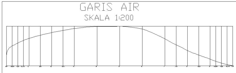
Gambar 2.05. Curve Selection Area dan Bentuk Garis Air
