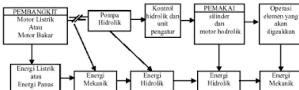
Gambar 1. Diagram alir sistem hidrolik
