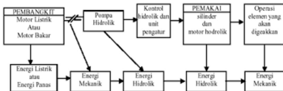
Gambar 1. Diagram alir sistem hidrolik
