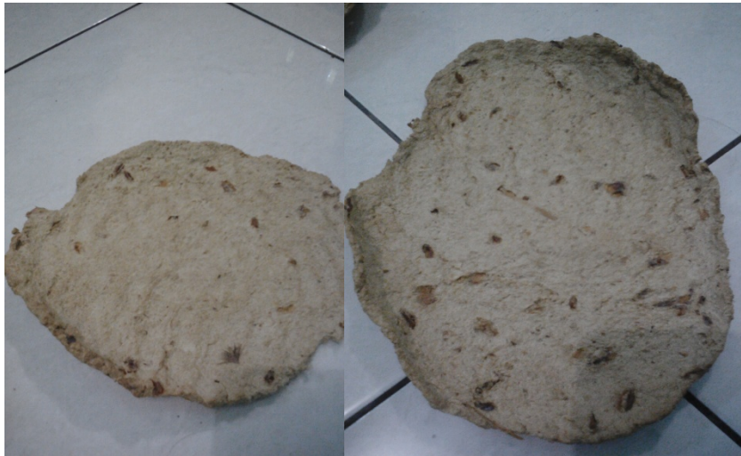
Gambar 6. Hasil Pulp Percobaan 1 90 °C dan 60 menit
