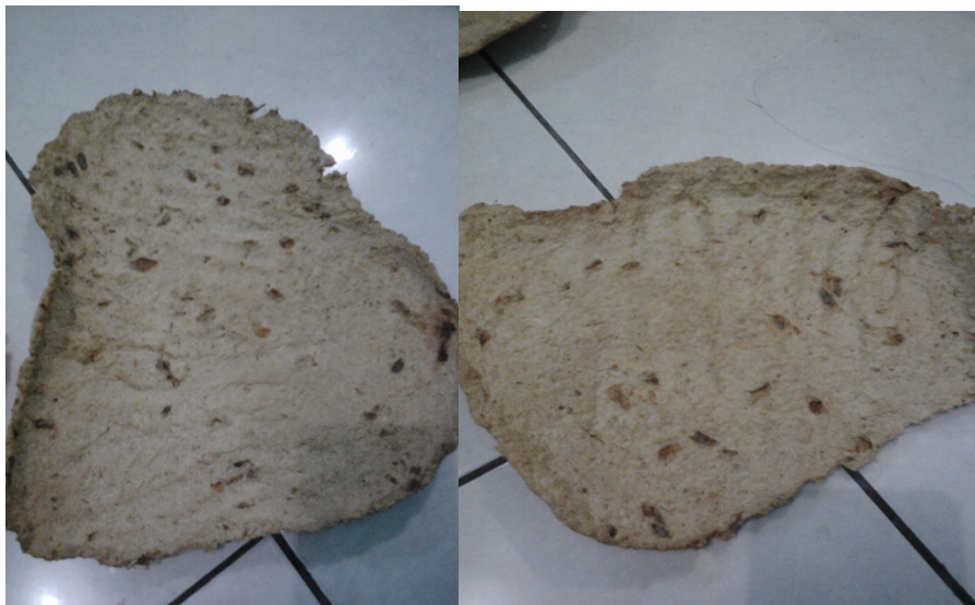
Gambar 8. Hasil Pulp Percobaan 3 90 °C dan 80 menit
