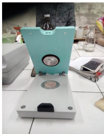
Ilustrasi 6. Alat a_w meter untuk Pengujian Aktivitas Air
