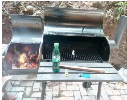
Ilustrasi 4. Alat Smoking Cabinet Siap untuk Proses Pengasapan
