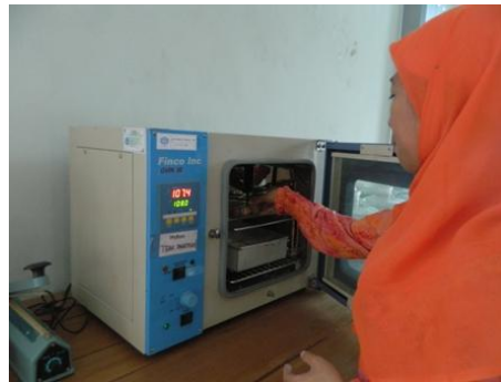
Ilustrasi 5. Sampel Ikan Asap Dimasukkan ke Oven untuk Pengujian Kadar Air
