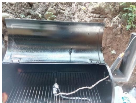
Ilustrasi 3. Alat Thermocouple Dipasang untuk Memantau Suhu pada Smoking Cabinet
