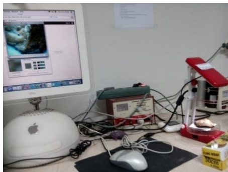
Ilustrasi 9. Alat Colorimeter dengan Sampel dari Ikan Asap untuk Pengujian Warna
