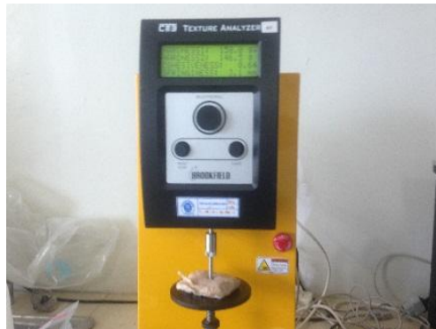
Ilustrasi 8. Texture Analyzer untuk Pengujian Tekstur
