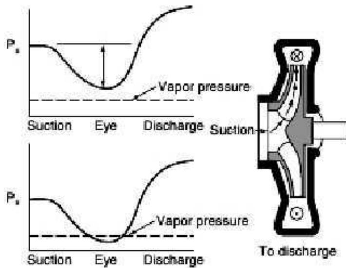
Gambar 2.16 Perubahan tekanan pada sisi isap pompa
