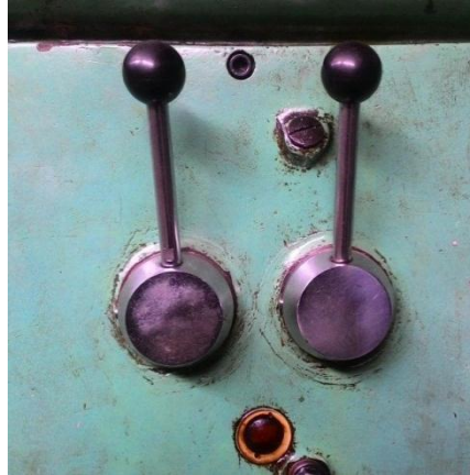
Gambar 3.3. Tuas pengatur putaran spindle
