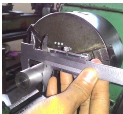
Gambar 3.26. Pengukuran diameter benda kerja
