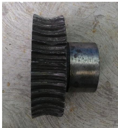
Gambar 3.20. Roda gigi cacing yang rusak
