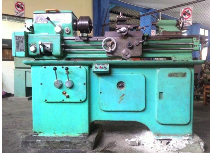
Gambar 3.1. Mesin bubut Kiangsi C6127A
