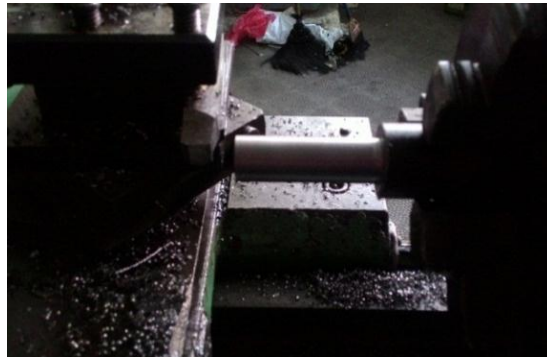
Gambar 3.27. Proses pembubutan rata
