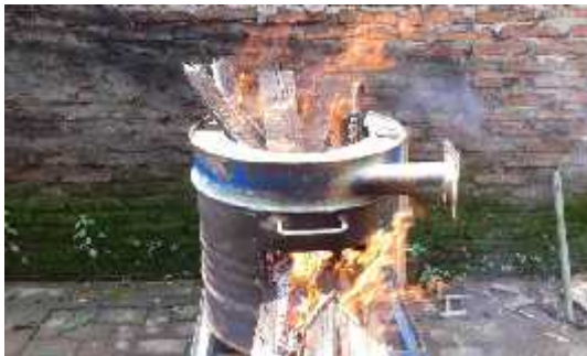
Pengerasan Dinding Tungku
