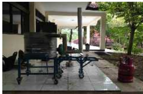
Tungku Pengecoran Aluminium
