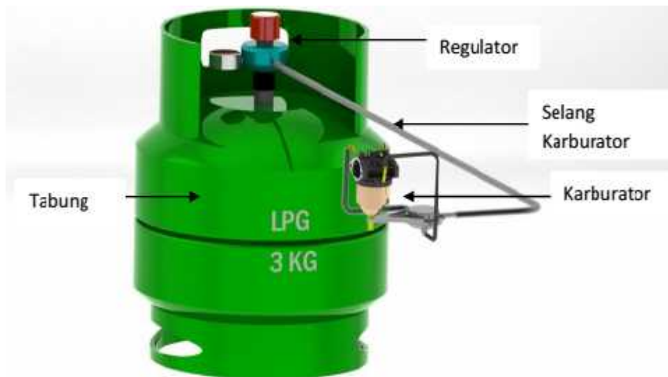
Gambar 2.4 skema sistem bahan bakar LPG pada genset
