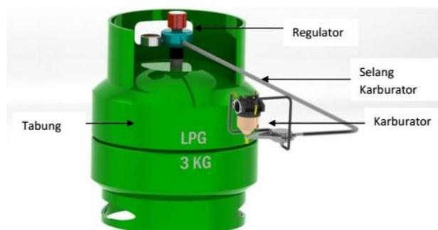
Gambar 2.3 skema sistem bahan bakar LPG pada genset
