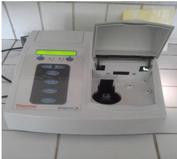
Gambar 12. Sampel pada kuvet dan dimasukkan dalam alat spektrofotometer
