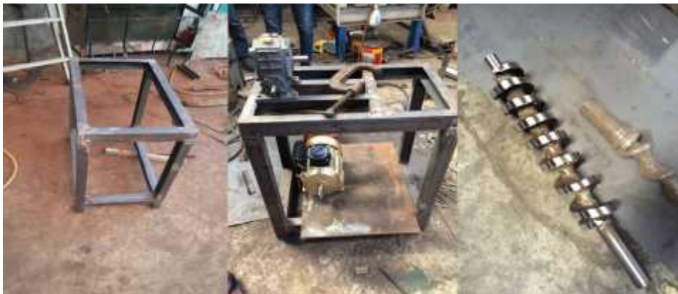
Lampiran 2. Foto proses pembuatan alat screw press
