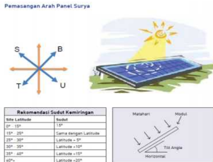
Gambar 2.1. Pemasangan arah panel surya
