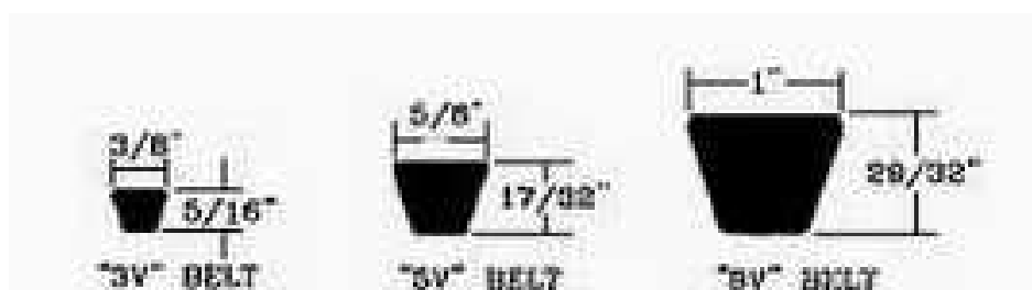
Gambar 2. 2 V-Belt Konvensional Tipe Sempit
