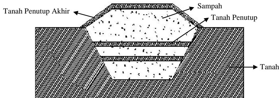
Gambar 2.4. Sistem Controlled Landfill (Sumber: Damanhuri dalam Setyowati, 2007)
