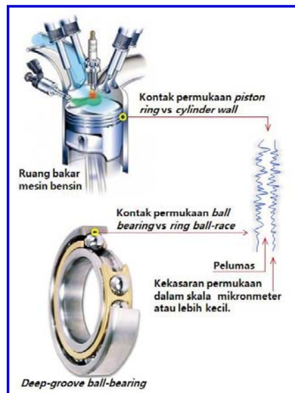
Gambar 1.1 Gesekan yang terjadi pada piston-ring dan ball-bearing (Aghurri, 2010)
