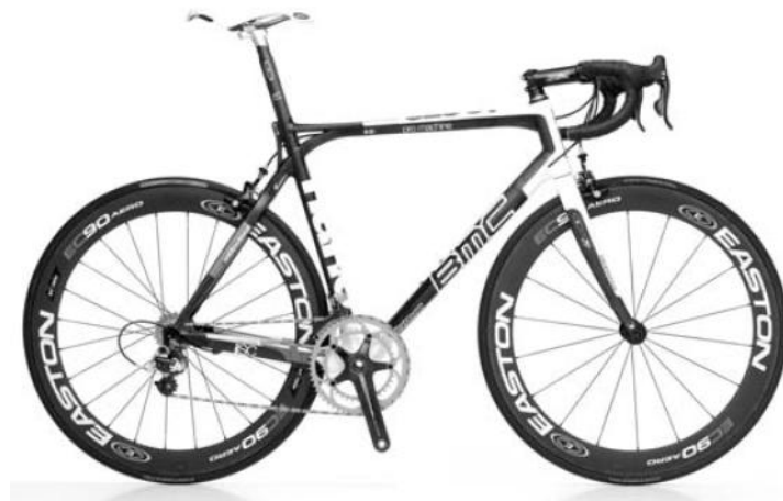
Gambar 2.15 Sepeda balap BMC Pro Machine SLC01 dengan frame mengandung carbon nanotubes [18].
