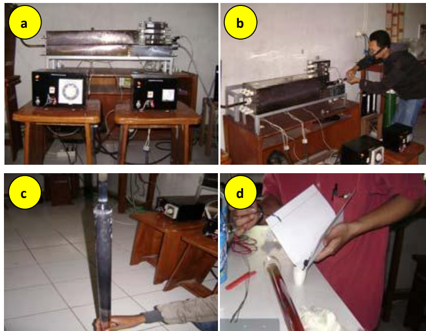
Gambar 3.10 Proses sintesis CNT dengan metode spray pyrolysis: a) Sistem peralatan yang digunakan; b) Proses sintesis sedang dijalankan; c) Hasil material CNT yang terdapat di dalam tabung quartz; d) Pengambilan material CNT dari tabung quartz [13].
