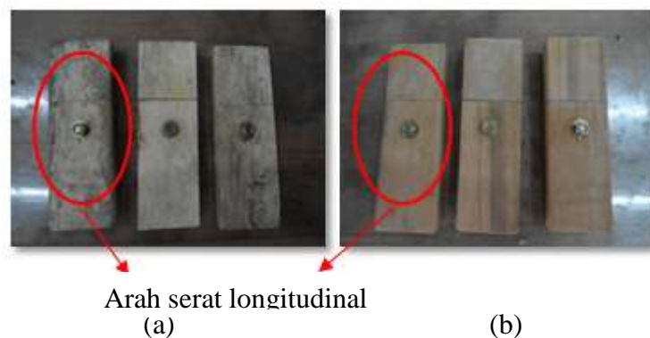
Gambar 3.9 Spesimen untuk pengujian kekuatan sambungan sejajar kayu dengan sambungan 1 baut : a. Kayu karet, b. Kayu bengkirai.
