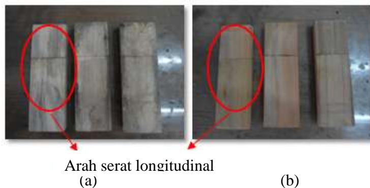
Gambar 3.8 Spesimen untuk pengujian kekuatan sambungan sejajar kayu dengan sambungan lem epoxy : a. Kayu karet, b. Kayu bengkirai.
