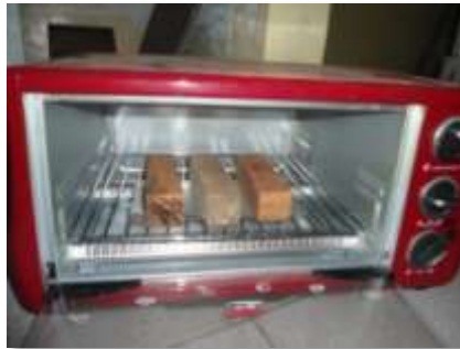
Gambar 3.3 Pengeringan kayu dengan menggunakan oven.
