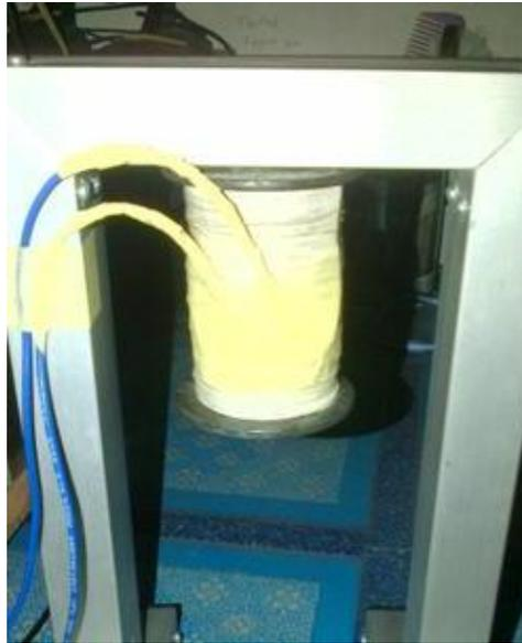
Gambar 2.7 Solenoida yang Dibuat.
